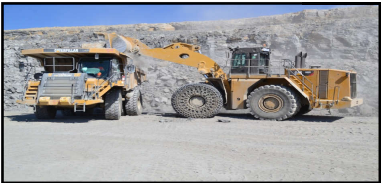
Figure IV.2 : L'opération de Chargement dans la carrière. (prise le 14/03/2017)
