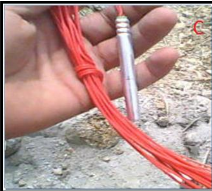
Figure 7 : Détonateur électrique à Micro-Retard DMR
