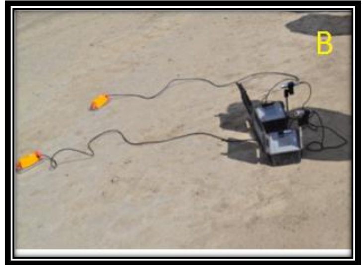
Figure 2 : Enregistreur des vibrations (sismographe)
