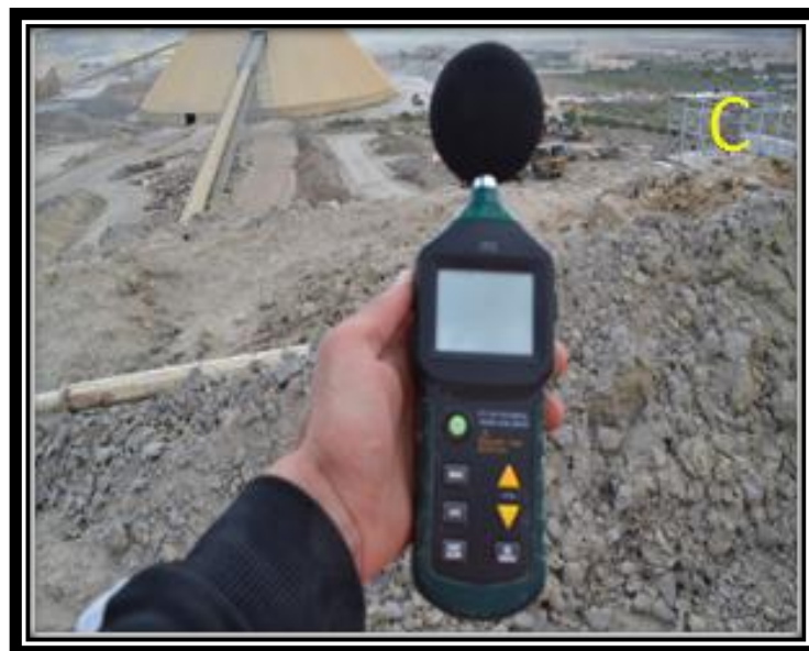
Figure 3 : Appareil mesurant l'effet sonore dû à l'explosion
