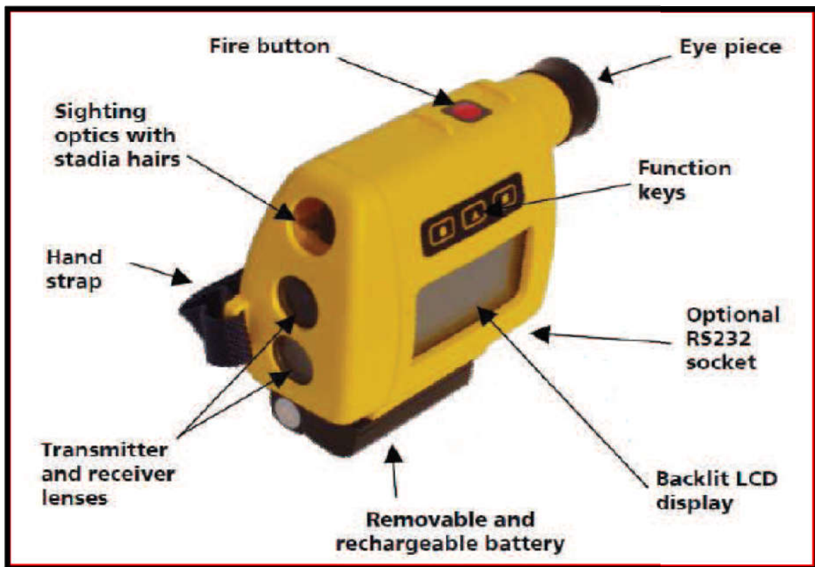
Figure V.4 : Description de l'appareil LaserAce® [17].
