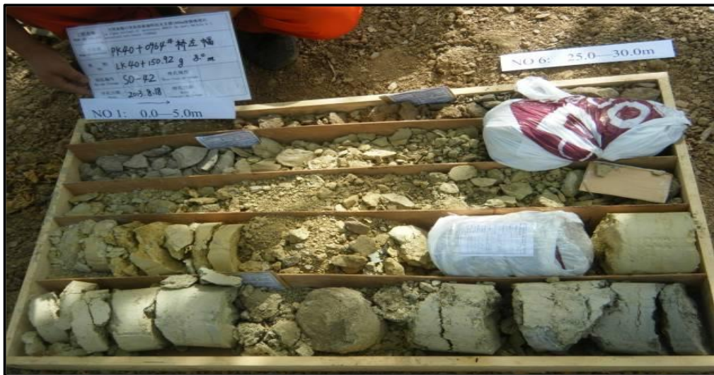
Figure III. 9: Carottage d'échantillon d'argile peu plastique, dure.
