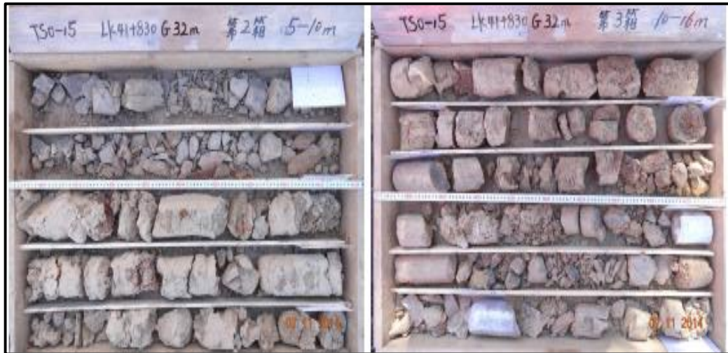
Figure III. 12 : Schiste intensément altérée en graviers.
