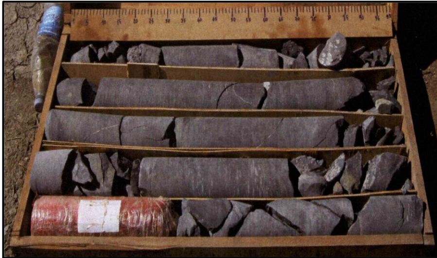
Figure III. 10 : Marne faiblement altérée
