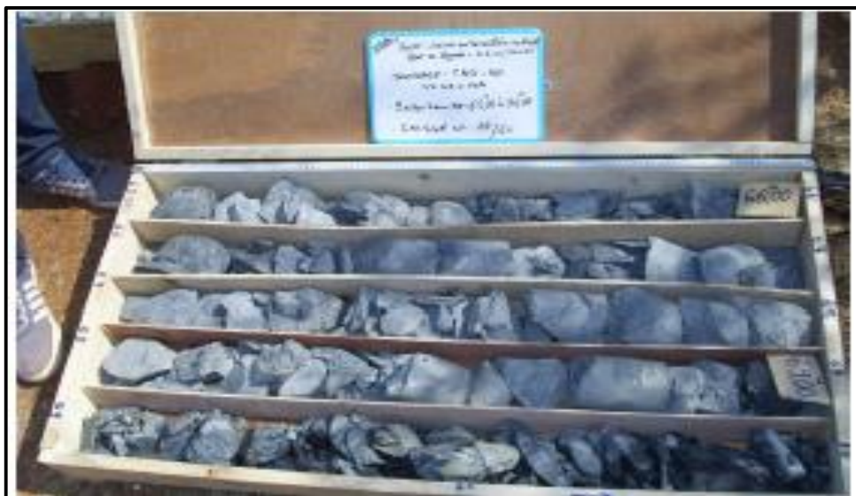
Figure III. 11 : Schiste altérée.
