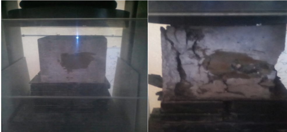
Figure Erreur ! Il n'y a pas de texte répondant à ce style dans ce document.-19 : compression simple d'une éprouvette cubique
