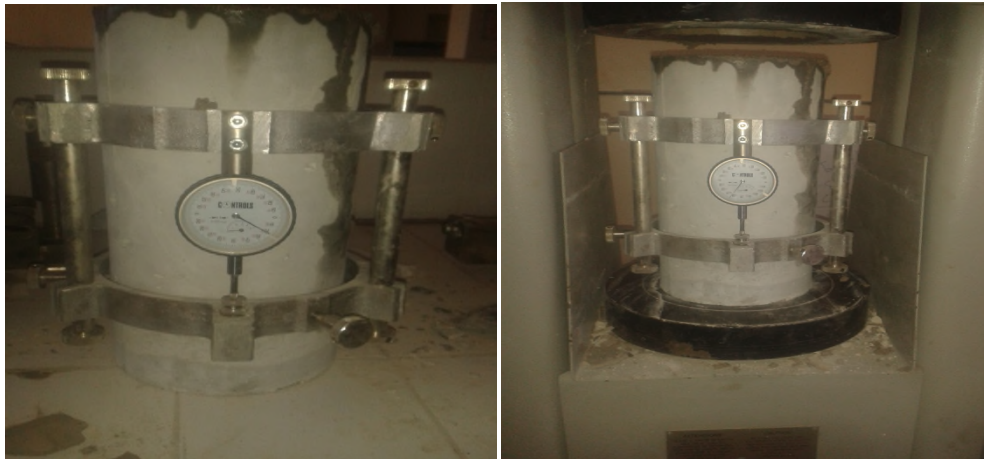
Figure Erreur ! Il n'y a pas de texte répondant à ce style dans ce document.-23: mesure de module d'élasticité
