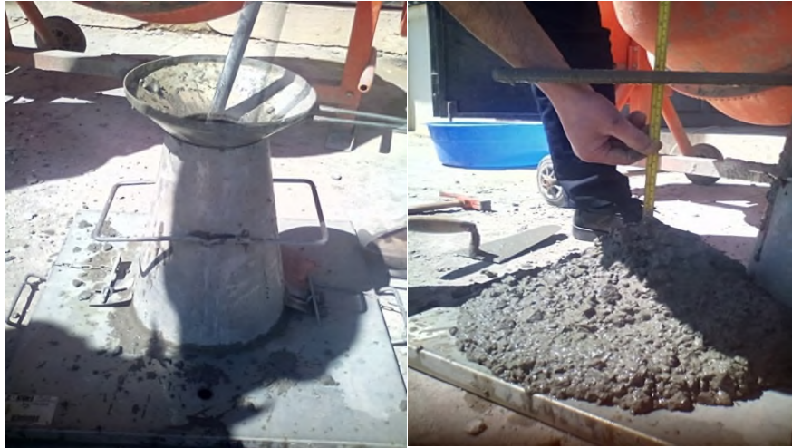
Figure Erreur ! Il n'y a pas de texte répondant à ce style dans ce document.-16 : appareil de mesure de l'affaissement
