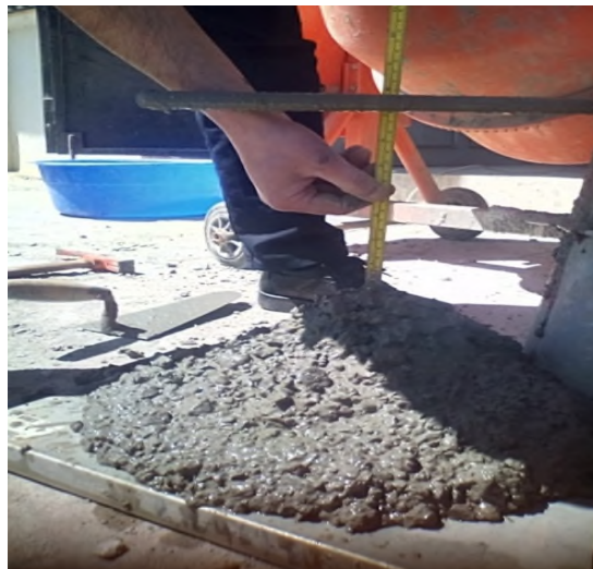
Figure Erreur ! Il n'y a pas de texte répondant à ce style dans ce document.-4 : Mesure de l'affaissement. [13]
