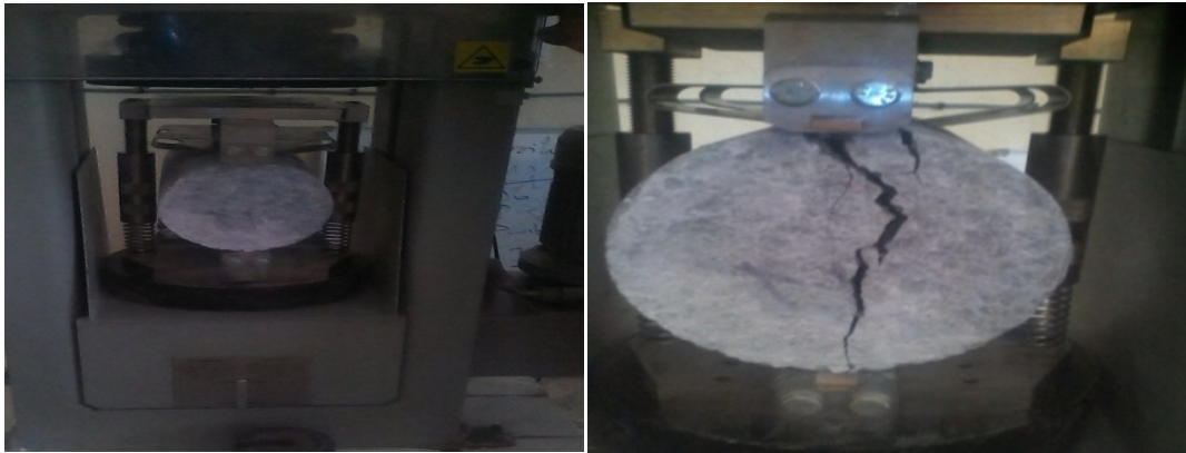
Figure Erreur ! Il n'y a pas de texte répondant à ce style dans ce document.-20: traction par fendage d'une éprouvette
