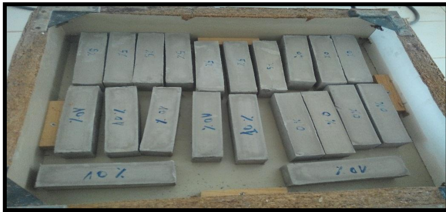
Figure V.4: L'ensemble des briques confectionnées après le séchage à l'étuve.
