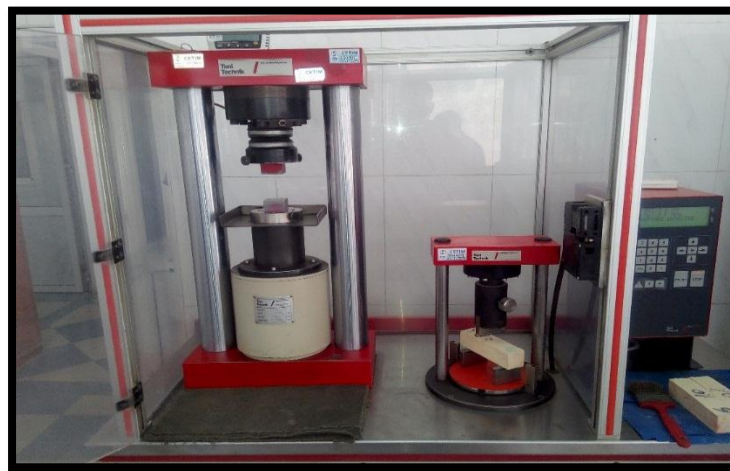
Figure V.9 : Appareil de la résistance à la compression et à la flexion.
