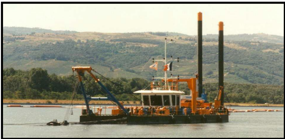
Figure I.6 : aspirateur stationnaire avec conduite de refoulement [8].
