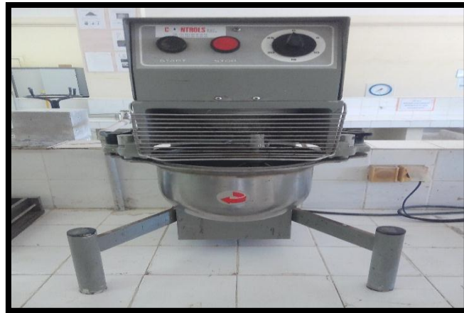
Figure V.2: Un malaxeur utilisé pour le mélange de la pâte.
