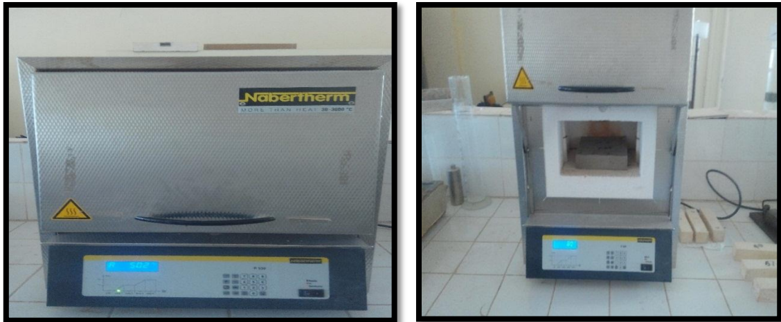
Figure V.5: Le four utilisé pour la cuisson des briques.
