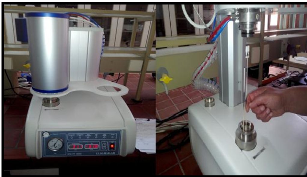
Figure III.9 : Appareil d'analyse ATD/ATG.
