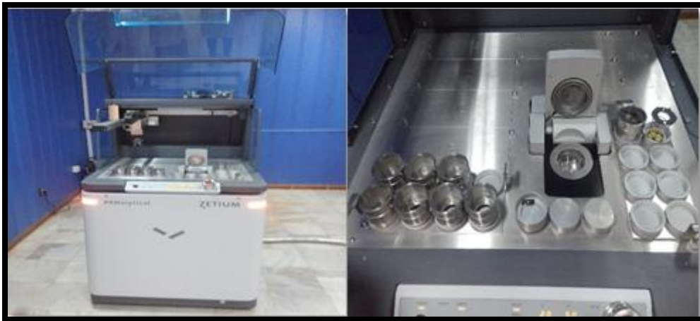
Figure III.7 : Appareil à fluorescence X à gauche et à droite les moules dont on met les échantillons (la pastille) pour l'analyse.
