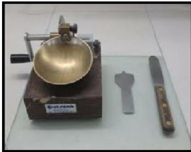
Figure III.13 : Appareil de Casagrande [66].
