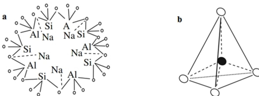
Figure I.4 : Interconnexion des tétraèdres entre eux par des atomes d'oxygène [20].
