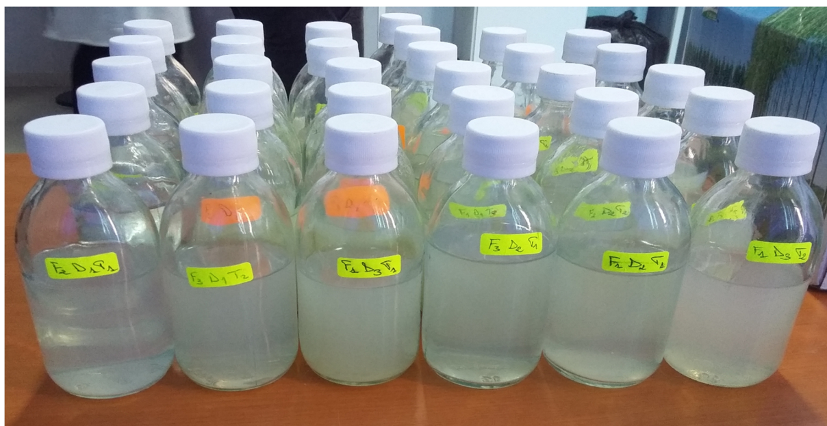
Figure 11 : les solutions recueillis après le traitement avant filtration a 0.45 µm (M.H, le 02/06/2017)
