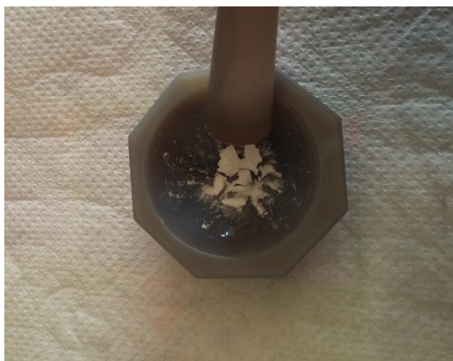
Figure II.3 : La préparation de la pastille (M.H, le 30/04/2017)
