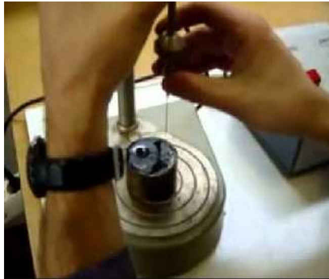
Figure II.17 : Essai de pénétrabilité à l'aiguille (photo prise en Mars 2017).
