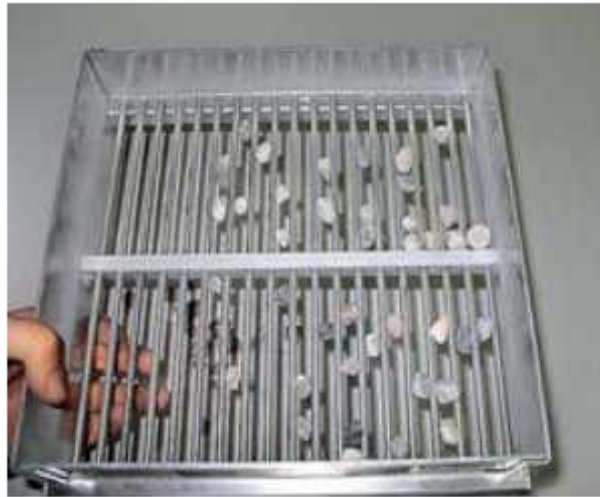
Figure II.6 : Tamisage sur grilles à fentes (photo prise en Mars 2017).
