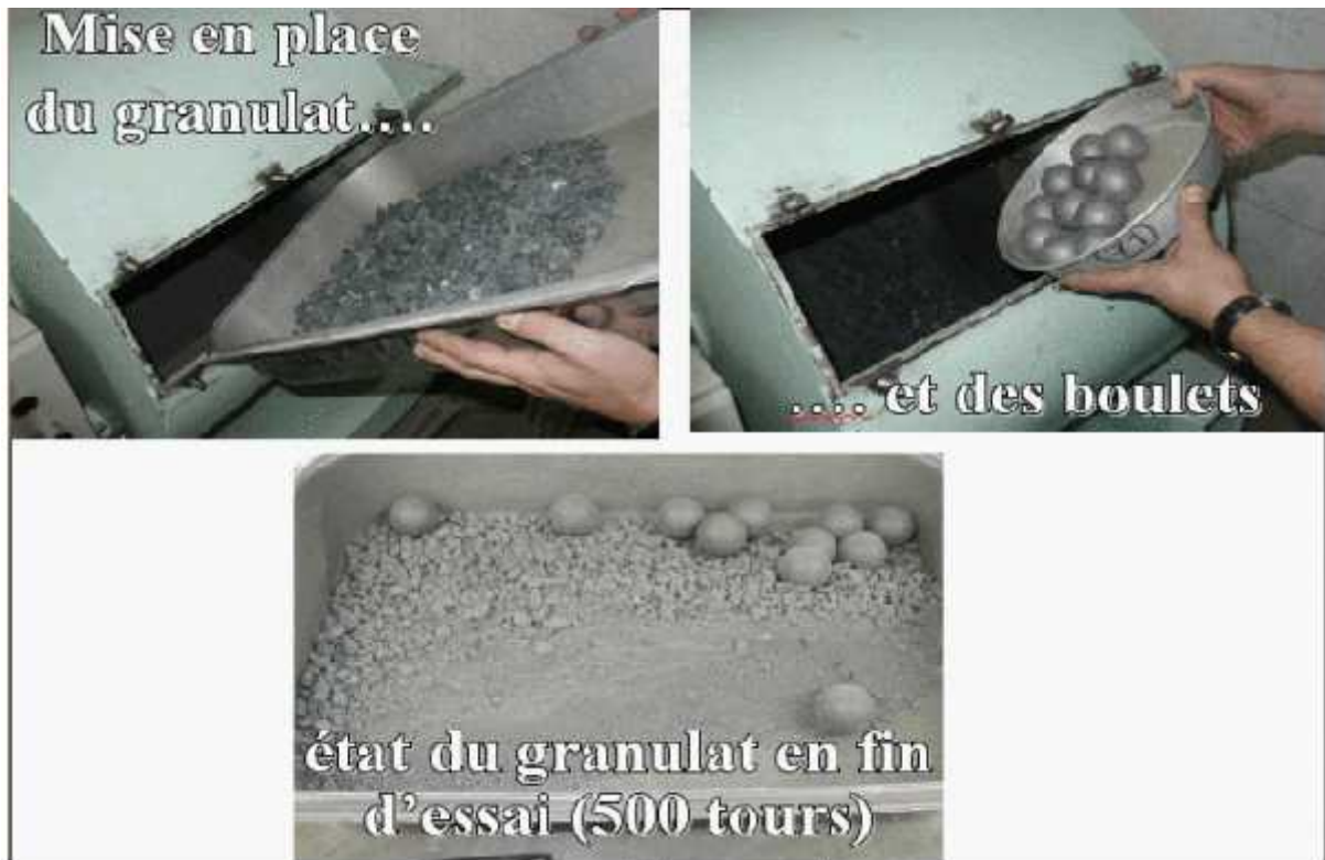
Figure II.12 : mode opératoire de l'essai Los Angeles [65].
