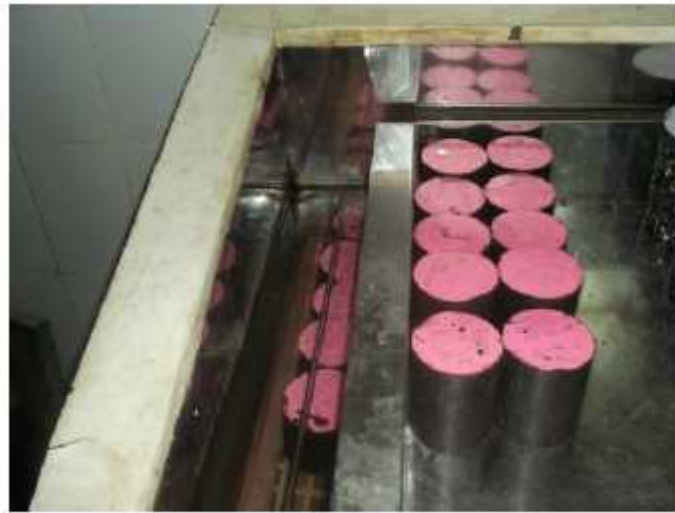
Figure II.21 : conservation des éprouvettes pour essai Duriez (photo prise en Mars 2017).
