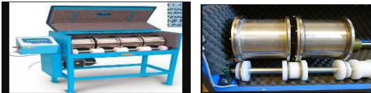
Figure II.9 : Appareil micro-Deval et cylindres [65].
