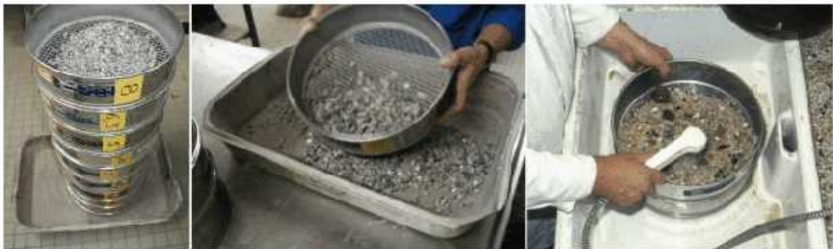
Figure II.4 : Lavage et tamisage des granulats (photo prise en Mars 2017).
