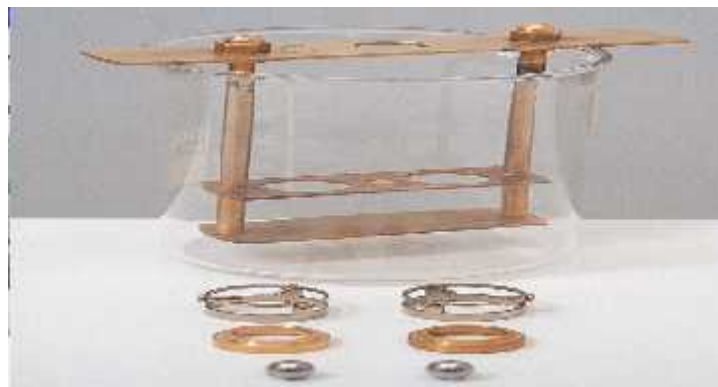
Figure II.13 : Appareillage Bille et anneau [17].
