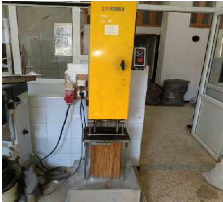
Figure II.19 : Dame de compactage (photo prise en Mars 2017).
