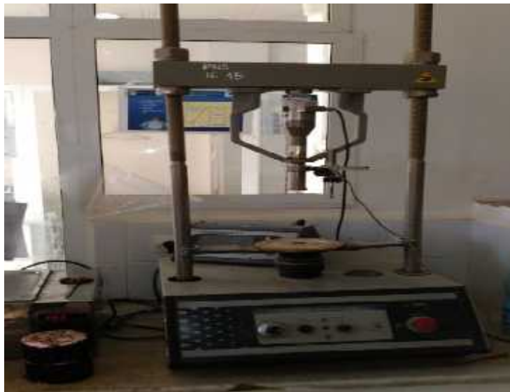
Figure IV.20 : presse Marshall (photo prise en Mars 2017).
