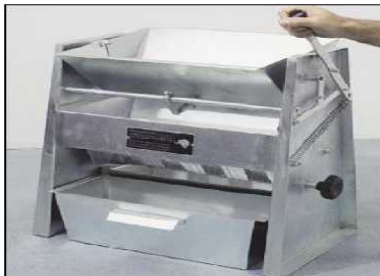
Figure II.1 : diviseur-échantillonneur [9].
