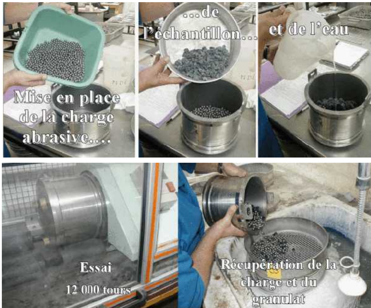
Figure II.10 : Mode opératoire de l'essai MDE [65].
