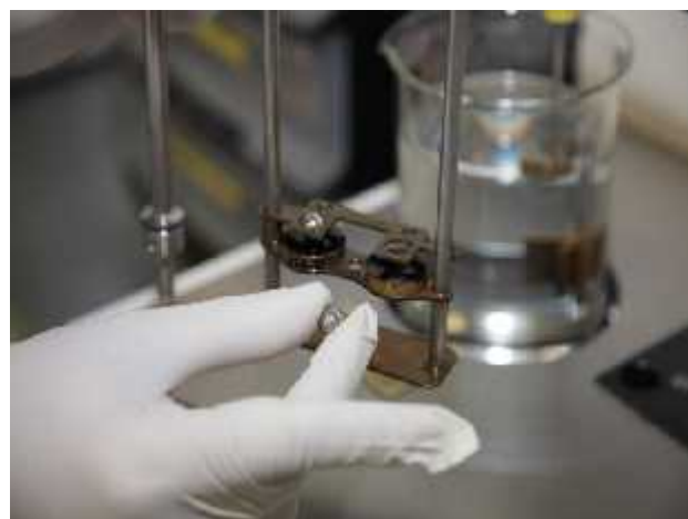
Figure II.14 : Remplissage des anneaux et préparation de l'essai [17].
