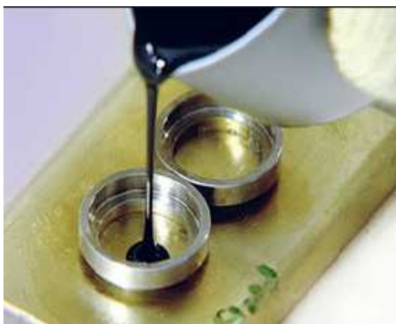
Figure II.14 : Remplissage des anneaux et préparation de l'essai [17].
