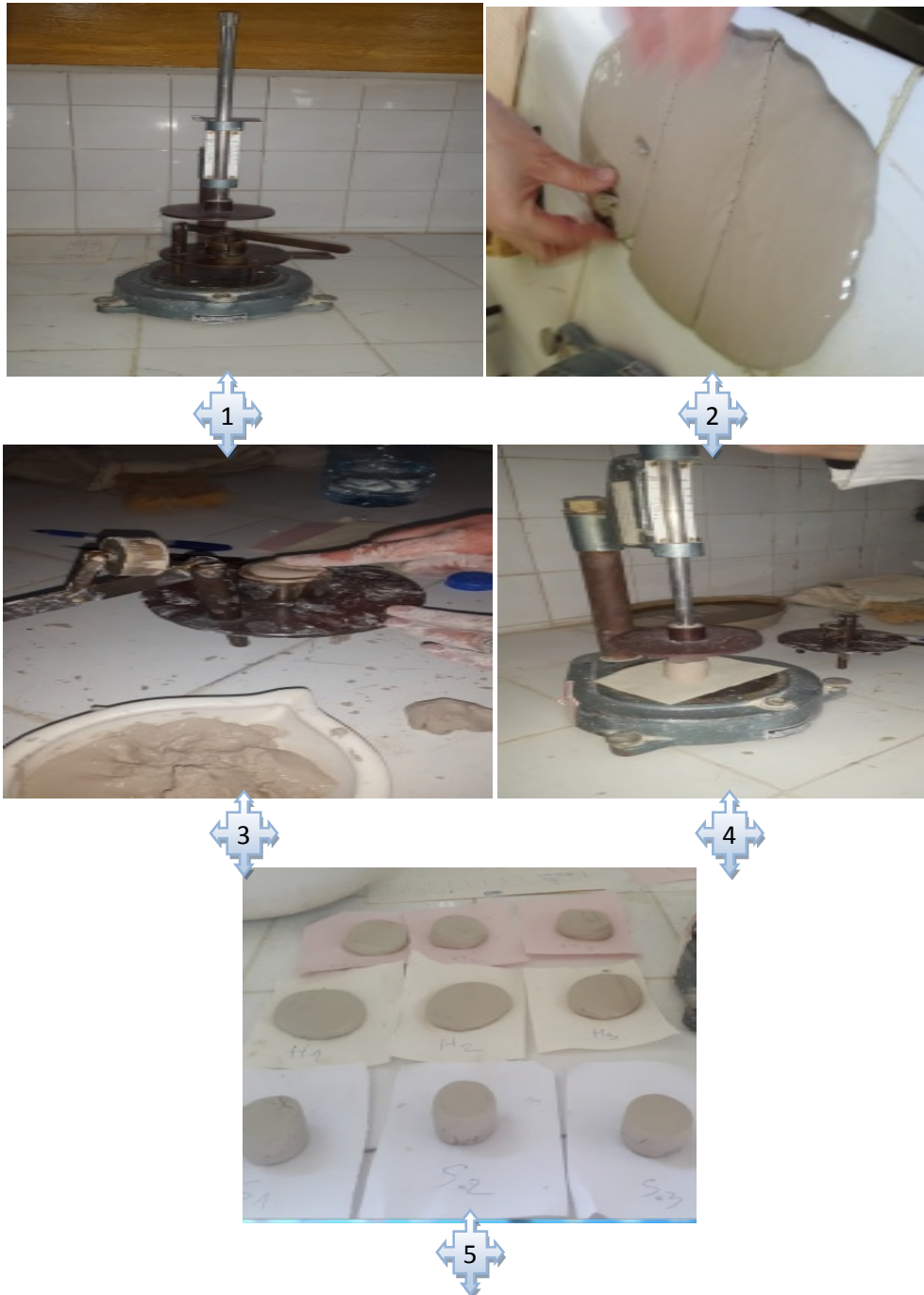
Figure II.10: Les étapes de test de plasticité.
