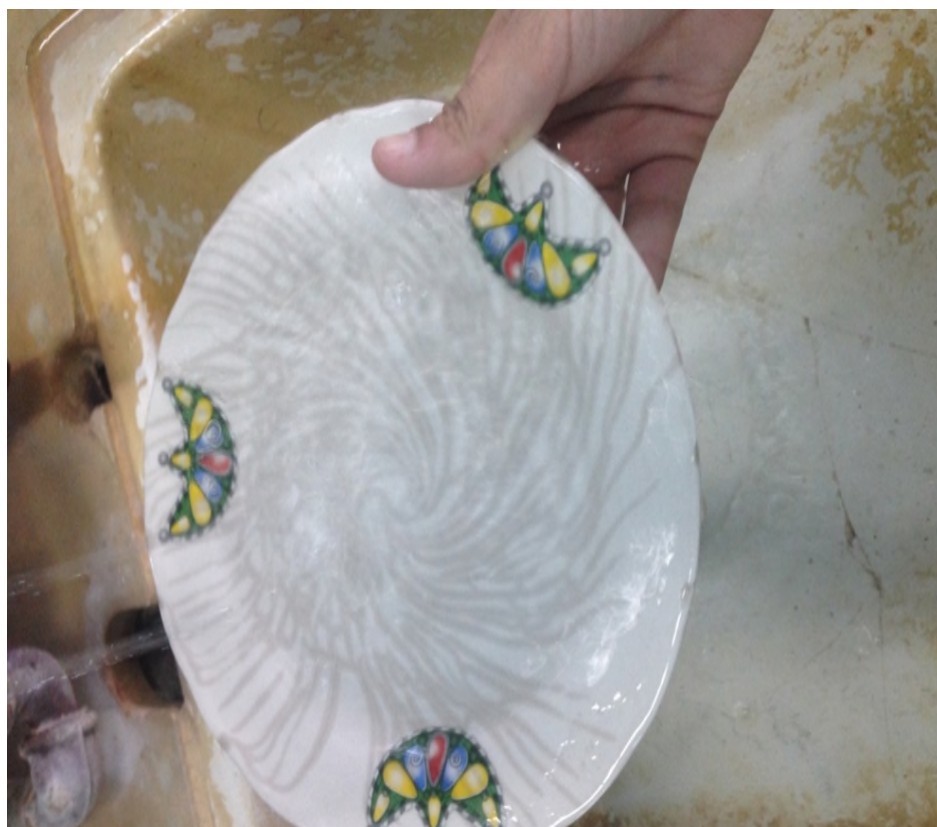
Annexe A.3: Le défaut de tressailage.
