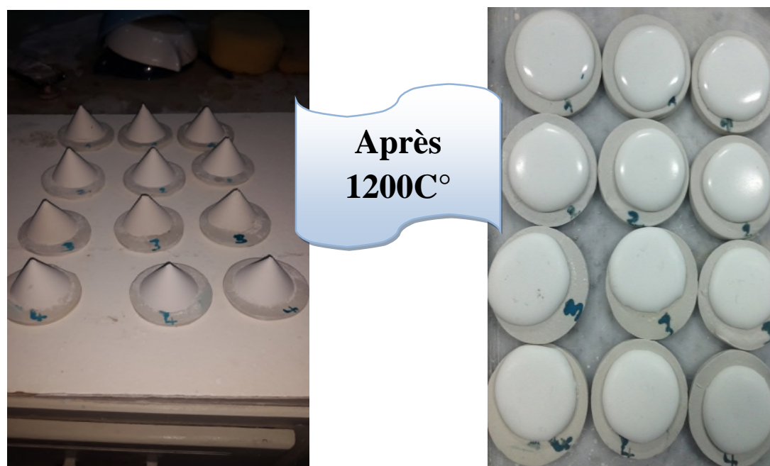
Figure III.5: Images des cônes de fusibilité de chaque dosage avant et après la cuisson.
