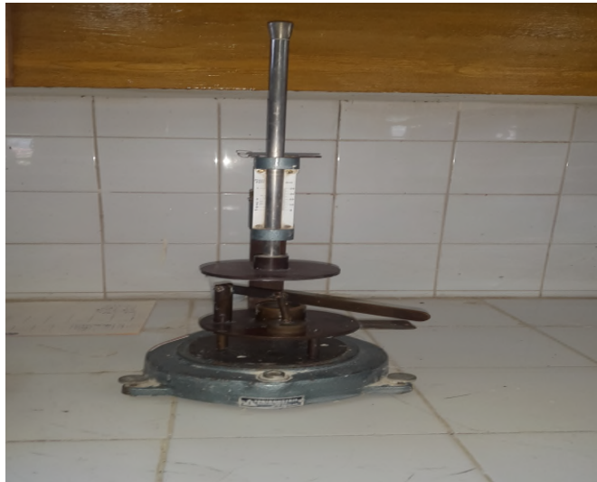
Figure II.9: L'appareil PFEFFERKORN de plasticité.
