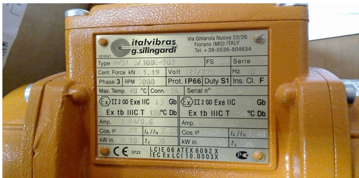
Figure II-8 : la plaque signalétique du vibrateur série MVSI 3/100E-S02 Italvibras
