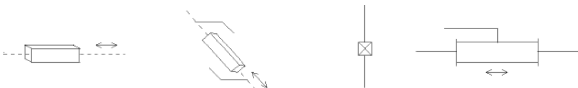
Figure I.3. Symbole de l'articulation prismatique.
