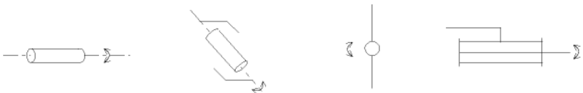
Figure I.2. Symbole de l'articulation rotoïde.
