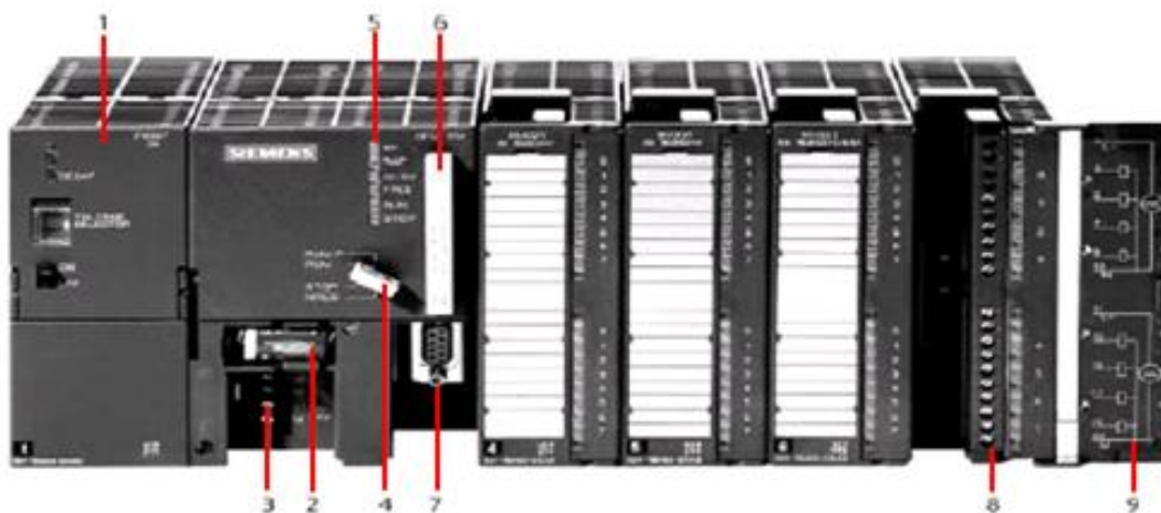
Figure III.2 : Automate modulaire (SIEMENS) [6]
