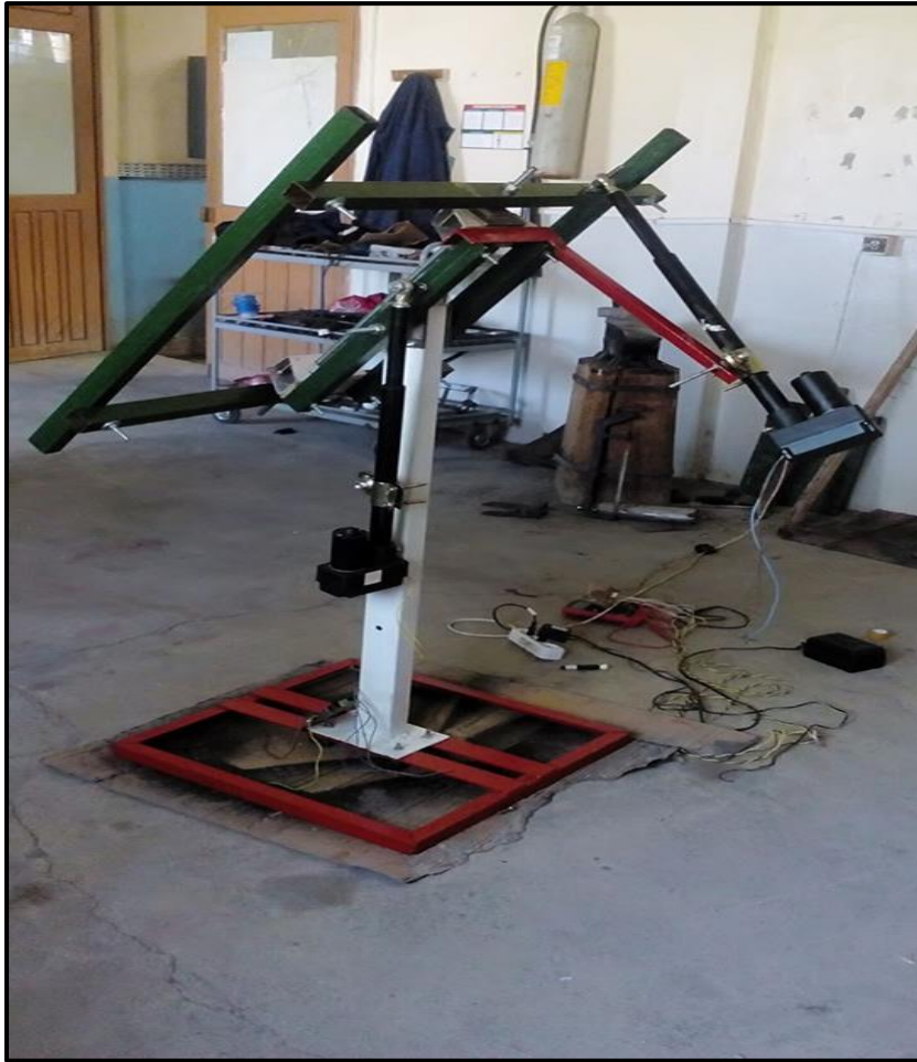
Photo 3.7 : Structure finale de notre suiveur solaire.
