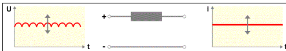
Fig. II.11 Circuit intermédiaire à courant continu variable
