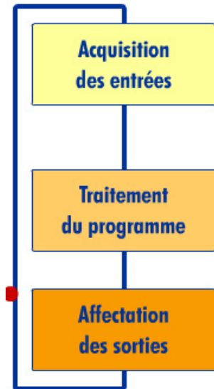
Figure II.3 : Principe de fonctionnement d'un automate
