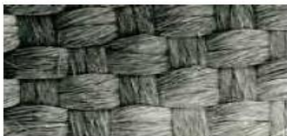
Figure II.6 : structure macroscopique d'une électrode en tissu active [17]
