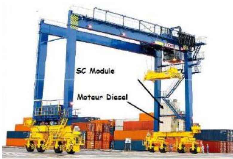
Figure II.10: Grues aéroportuaires au Japon combinant un moteur diesel et des modules Supercondensateurs [17].
