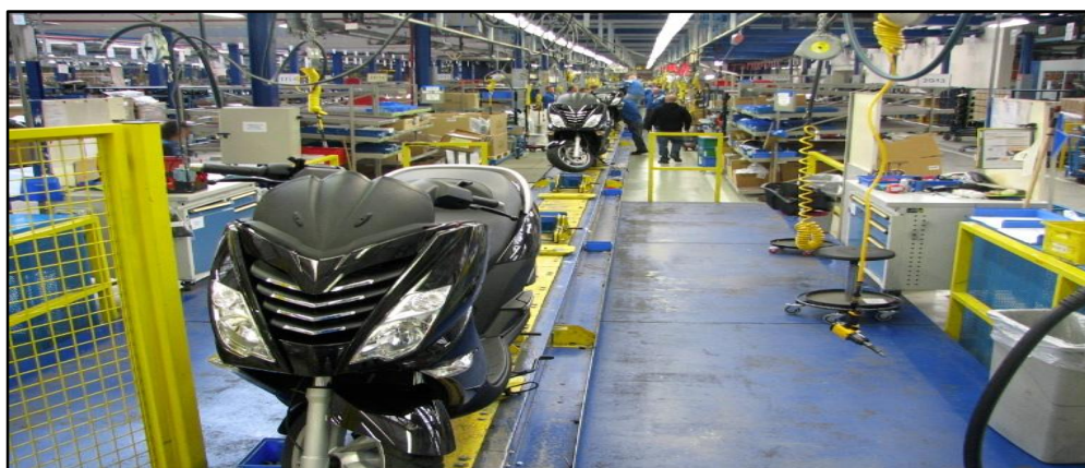
Figure II.4 Ligne de transfert (montage) d'un scooter
