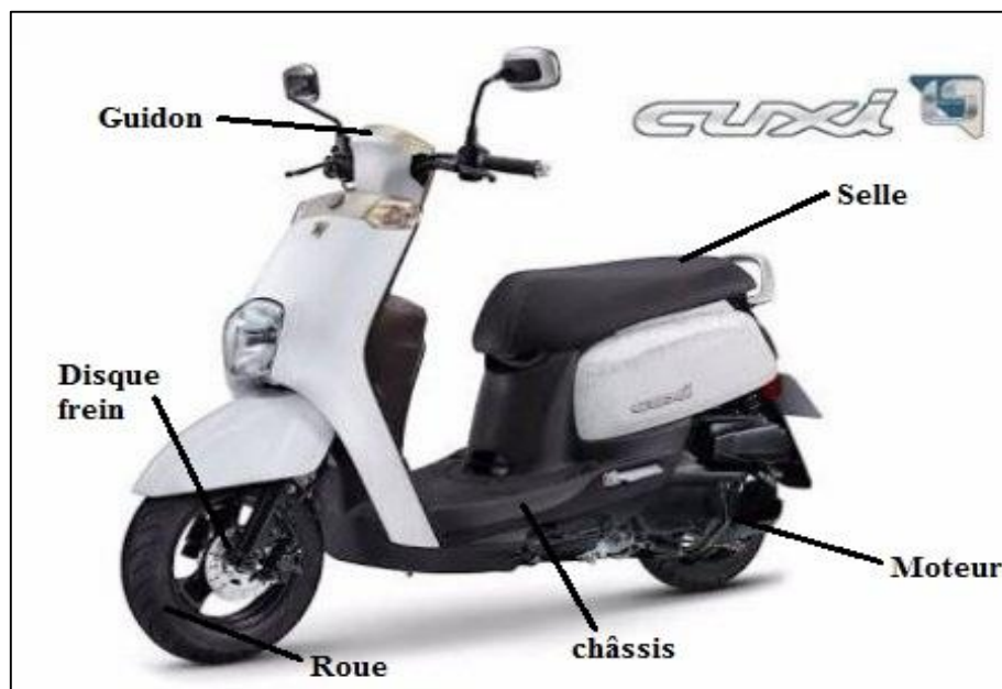
Figure I.1 Différents constituants d'un scooter
