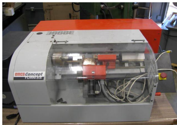
Figure 14 : Tour à commande numérique type emco concept turn 55 , à commande Siemens 810 T.
