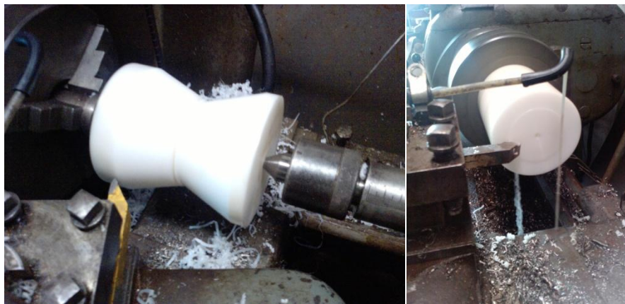
Figure 1 : Quelques erreurs faites lors de l'usinage du polyamide, à gauche utilisation d'outils pour l'usinage des aciers, à droite utilisation de la lubrification pour évacuer les copeaux.
