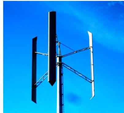
Figure I.5 : Éolienne type Darrieus H.
