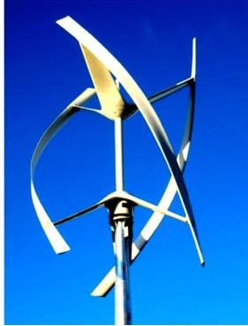
Figure I.4 : Éolienne type Darrieus.
