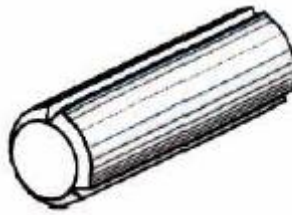
Figure (20) : Goupille cannelée.
