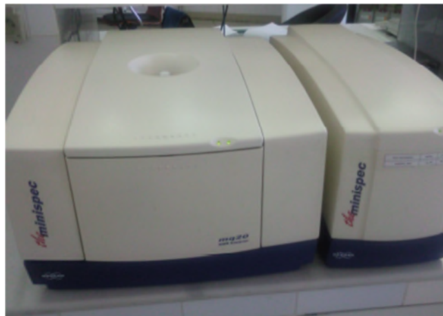
Figure 6 : Spectromètre à résonance magnétique nucléaire (RMN) pulsée à basse résolution (minispec mq 20, Germany).
