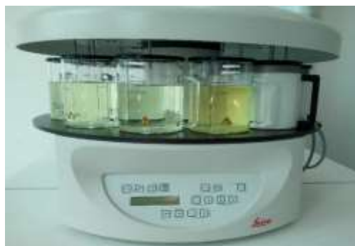
Figure 19: photo originale de l'appareil d'inclusion (photo originale).
