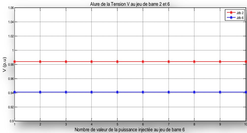
Fig.III.2 : Amplitude des tensions aux accès 2 et 6 (état initial)
