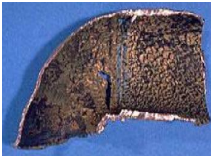
Figure I.18: Aspect visuel sur une pièce métallique de la corrosion érosion [15]
