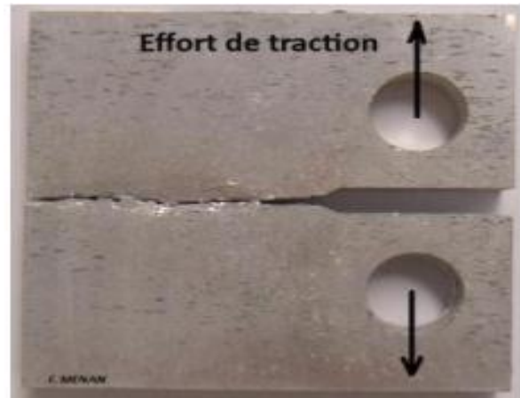
Figure I.16: Corrosion sous contrainte résultante d'un essai de traction. [15]
