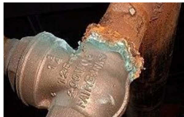
Figure I.10: Corrosion galvanique résultante d'un assemblage de deux métaux [15]
