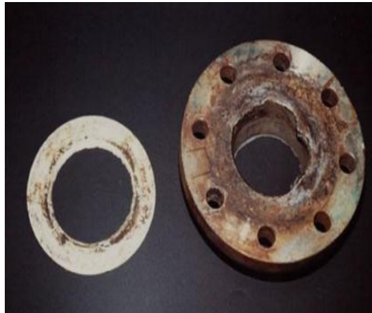
Figure I.9: Corrosion caverneuse sur une pièce métallique [15]
