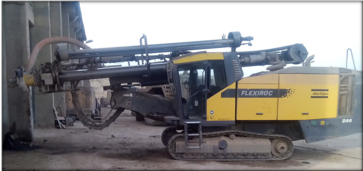
Fig.V. 1: Sondeuse d'ATLAS COPCO utilisée dans la carrière. [3]
