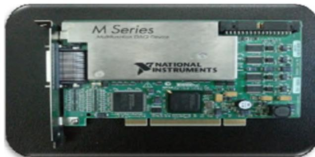
**Fig II.14** carte d'acquisition NI-PCI 6259
