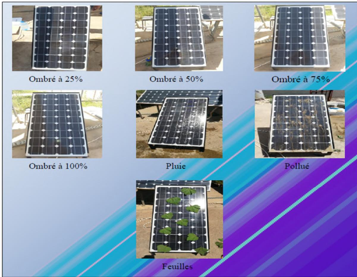
Fig. IV.1 Exemple de défauts de mismatch et d'ombrage.
