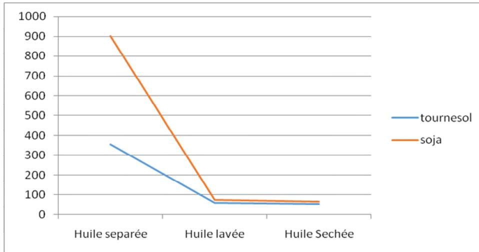
**Figure 8 : Courbe de la teneur en trace de savon à différents stades de raffinage des huiles de Soja et Tournesol.**
