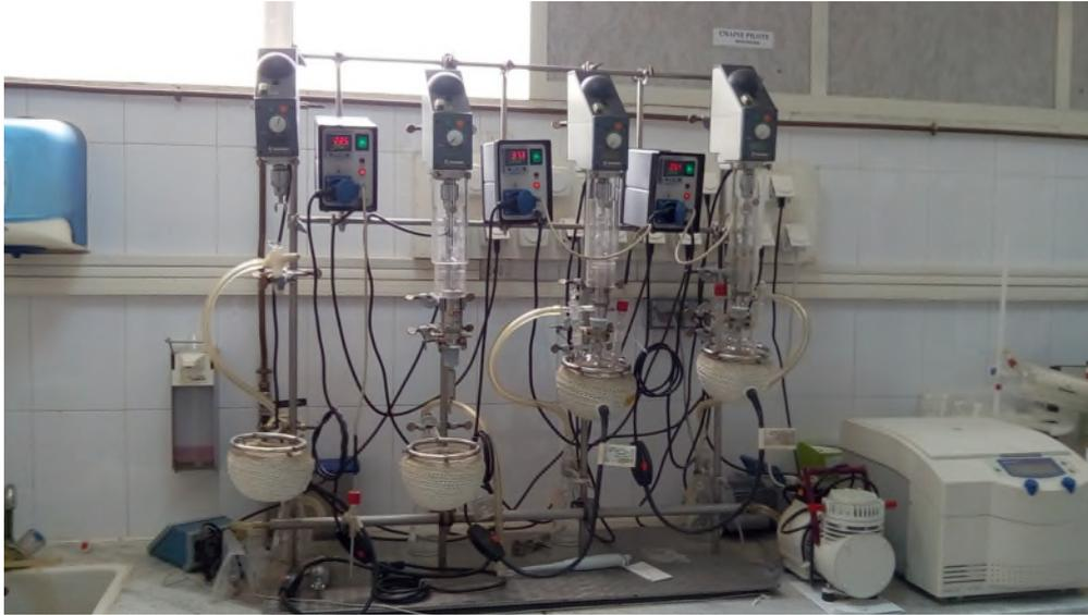
Figure 7 : Dispositif de décoloration.
