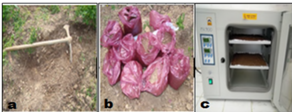
Figure 7 – Etapes de prélèvement et de préparation du sol. (a) prélèvement du sol sur le terrain, (b) transport du sol au laboratoire, (c) sol étuvé ( original ).
