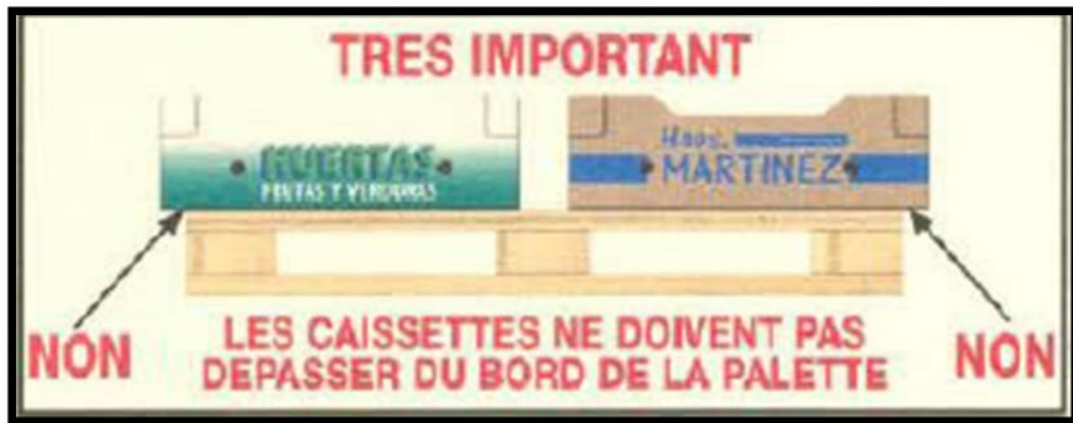
Figure III.4 Dépassement des caisses du bord de la palette
