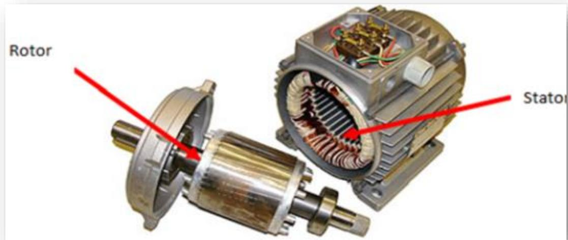
Figure 6 : Moteur asynchrone
