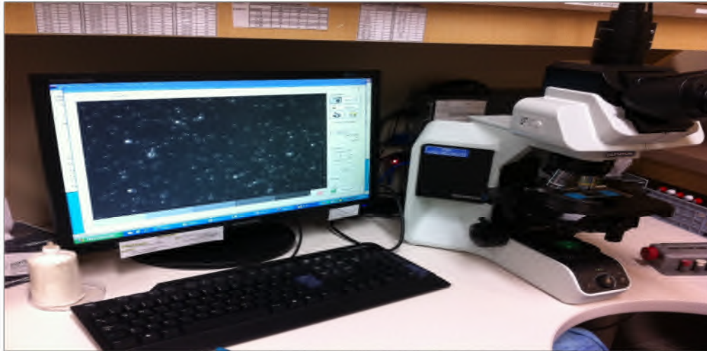
Figure 7 : Système CASA montée sur microscope(OPTMQ 2016)
