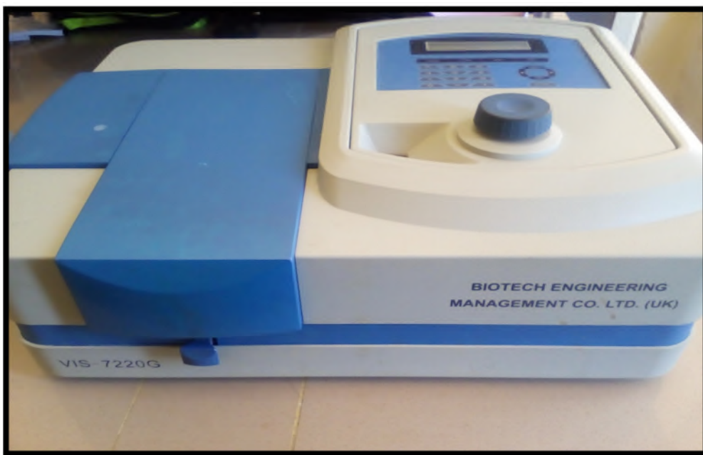
Figure 12 : un spectrophotomètre visible de marque (VIS 7220 G)de biotech Engineering Management.
