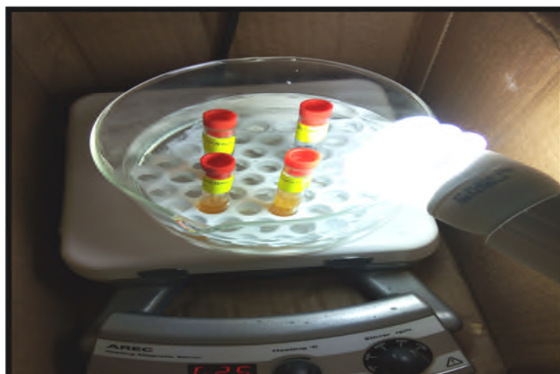
Figure 10: Photographie originale du dispositif utilisé dans l'étude de l'activité de la superoxyde dismutase.
