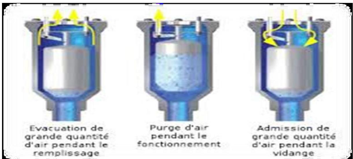
*Figure (VI.9) : Schéma explicatif du fonctionnement d'une ventouse*
