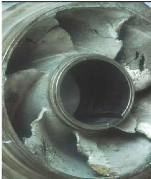
**Figure (V.7) :** Photo illustrant le phénomène de cavitation sur des aubes d'une pompe centrifuge
