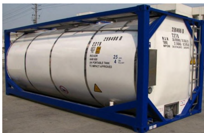
Figure n°5 : le conteneur-citerne (tank container)
