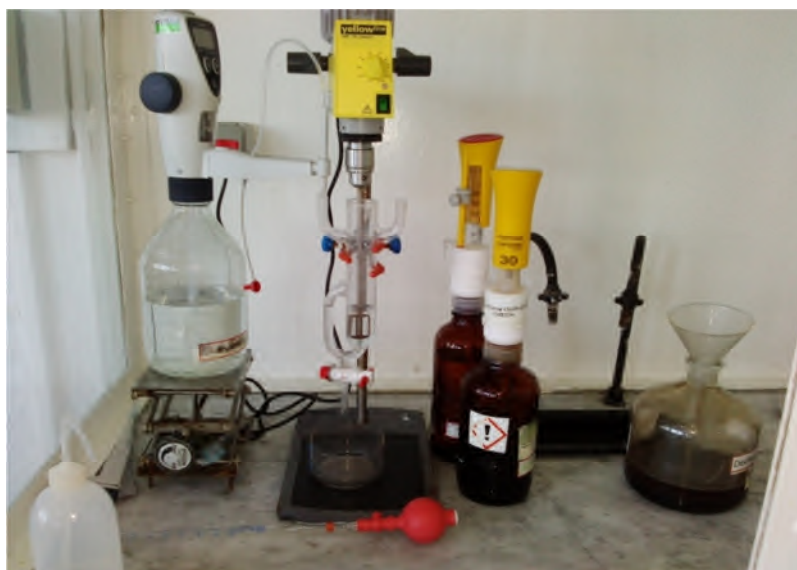
Figure 06: Montage expérimental pour la détermination de la teneur en matière active.
