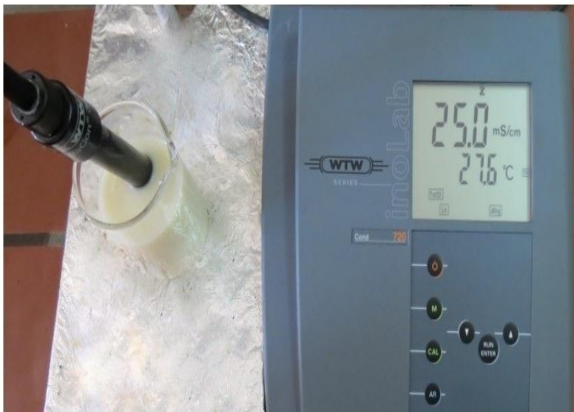
Fig. IV. 3 : Mesure de la conductivité volumique des solutions polluantes (Conductimètre)
