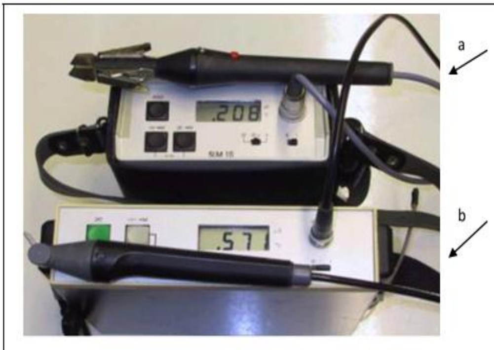
Fig. II. 2 : Dispositif allemand de surveillance de la sévérité de pollution SLM 10 (a : Sonde à électrodes planes, b : Sonde à électrodes linéaires)
