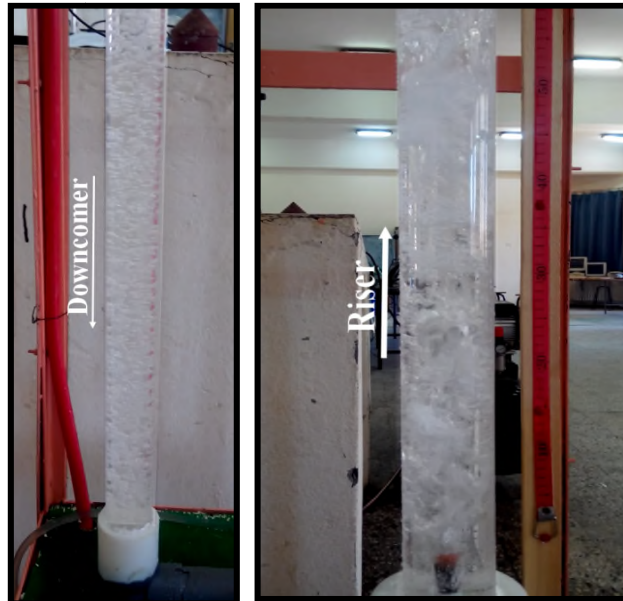
Figure III.5 Régime d'écoulement obtenu pour la phase liquide eau à débits d'air élevés
