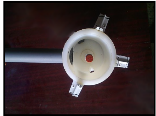
Figure II.13 : Montage de la jonction riser-downcomer
