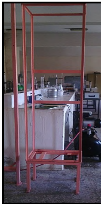
Figure II.11: Structure métallique fixée au sol
