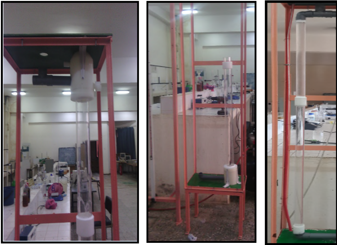
Figure II.21 : Montage du riser et du downcomer sur la structure métallique
