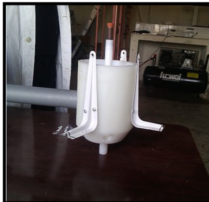
Figure II.14 : Montage du disperser dans la section de base
