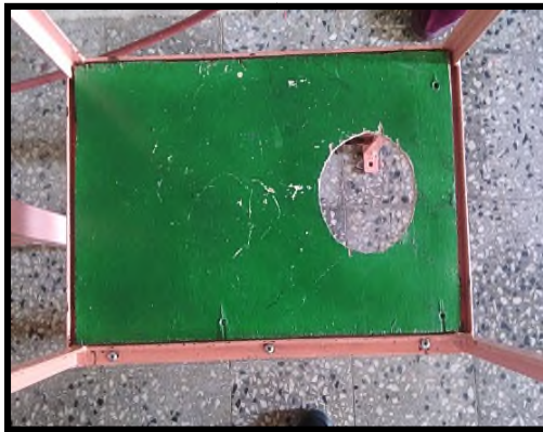
Figure II.12 : plaque en bois fixée sur la structure métallique
