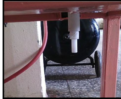
Figure II.16 : Sortie pour l'alimentation en air
