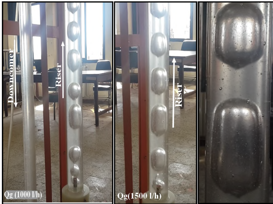
Figure III.8 régime d'écoulement obtenu pour la phase liquide CMC (20g/l) de Q_g = 1000 à 1500 l/h
