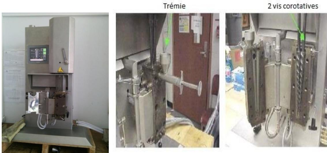
Figure II.6. Photos de la micro-extrudeuse
