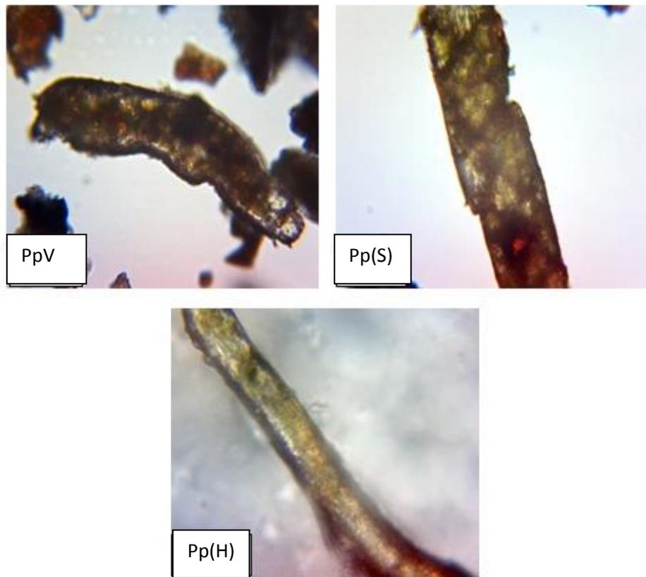
**Figure III.2.** Microscopie optique des fibres PpV, Pp(S) et Pp(H) grossissement (x40)
