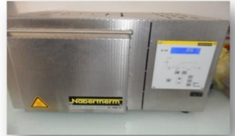
**Figure n°7 :** Le four à moufle utilisé pour le séchage (Photo Originelle).
