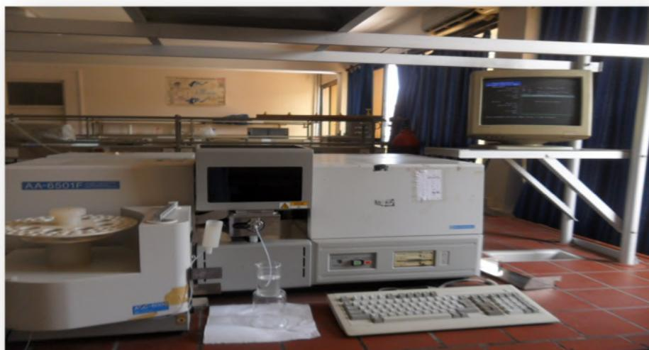
**Figure n°9** : Photo originale de l'appareillage de la Spectrométrie d' Absorption Atomique.
