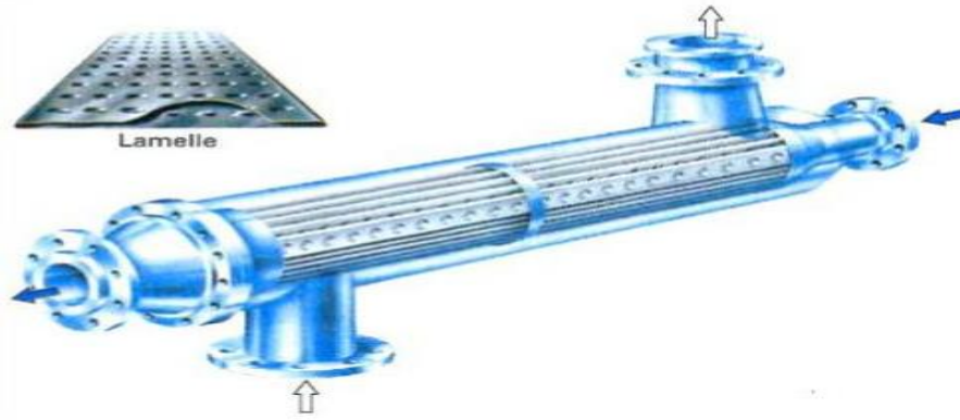
Figure XI : Echangeur lamellaire (document ALFA LAVAL) [1]
