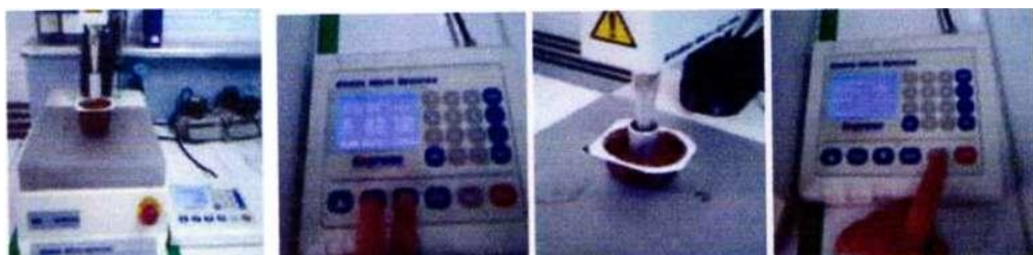
Figure N°08 : Etapes de la détermination de la viscosité avec le viscosimètre « Taxt Express »
