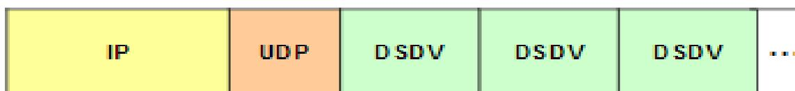
**Figure III.5 :** Encapsulation d'en-tête DSDV.
