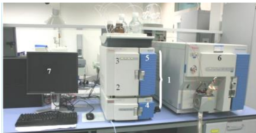
Figure 11 : Appareillage de la chromatographie en phase liquide couplée à la spectrométrie de masse en tandem (Photo prise à l'INCC)
