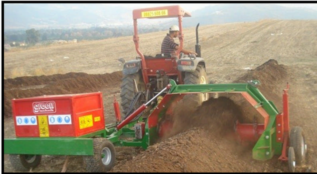
Figure 33 : Le retourneur des andains
