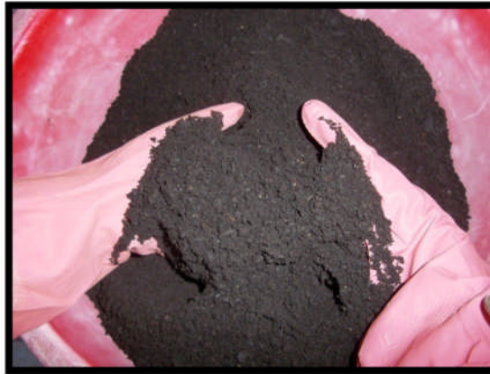
Figure 49 : Construction d'un échantillon global qu'on homogénéise parfaitement
