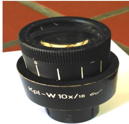
Figure 14: Photo originale d'un oculaire gradué.
