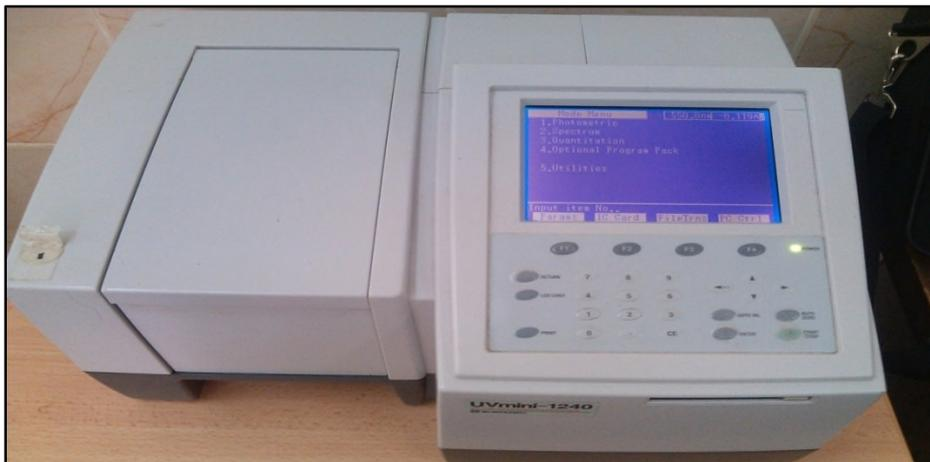
**Figure (2)** : Photographie du spectrophotomètre UV-Visible utilisé.
