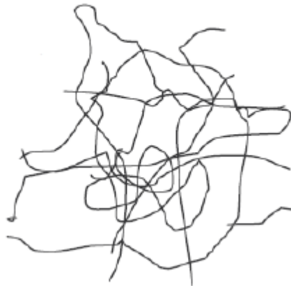
Figure I. 4 : Gel de silice obtenu par catalyse acide. [13]
