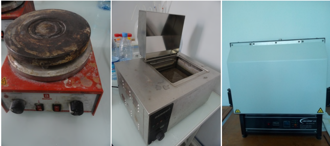
Figure II.8 : Photographie montrant respectivement (de gauche à droite) un agitateur magnétique, le bain-marie et le four utilisé pour le traitement thermique des poudres.
