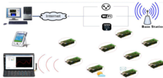
FIGURE 1.1 – Réseaux de Capteur Sans Fil (RCSF)
