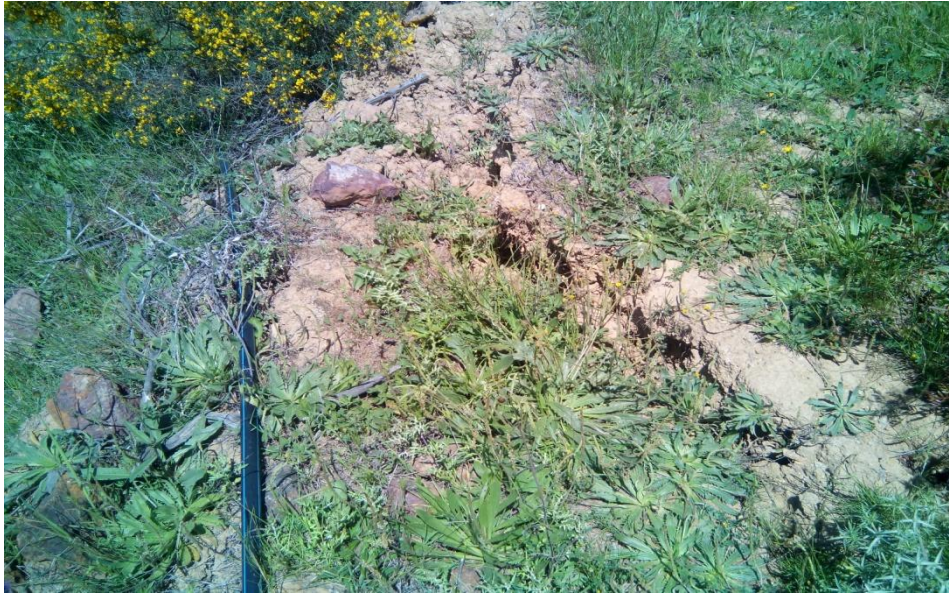
Figure 24 : Affaissement longitudinale, de notre site étudié à Ouendadja commune Berbacha Wilaya de Bejaia.
