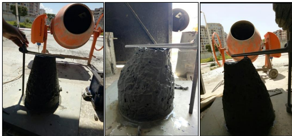
Figure II.18 : Essai de l'affaissement du B.Adj avec 250kg du ciment
