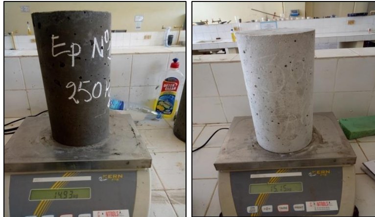
Figure II.25 : exemple de masse d'un béton à l'état frais et à l'état durcis.
