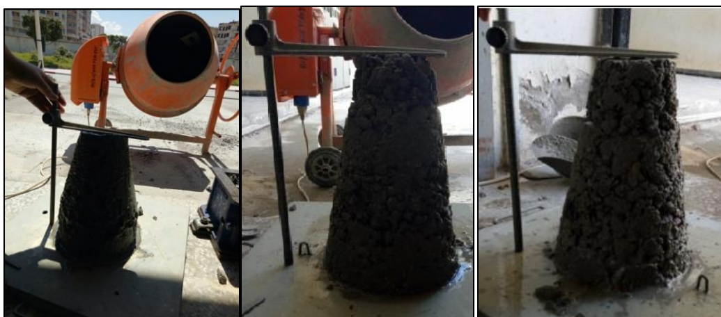
Figure II.21 : Essai de l'affaissement du B.FC avec 250kg du ciment
