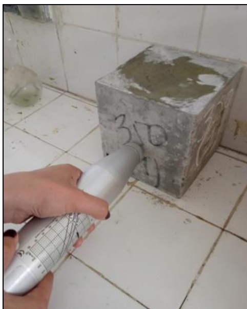
Figure II.28 : L'essai au scléromètre.
