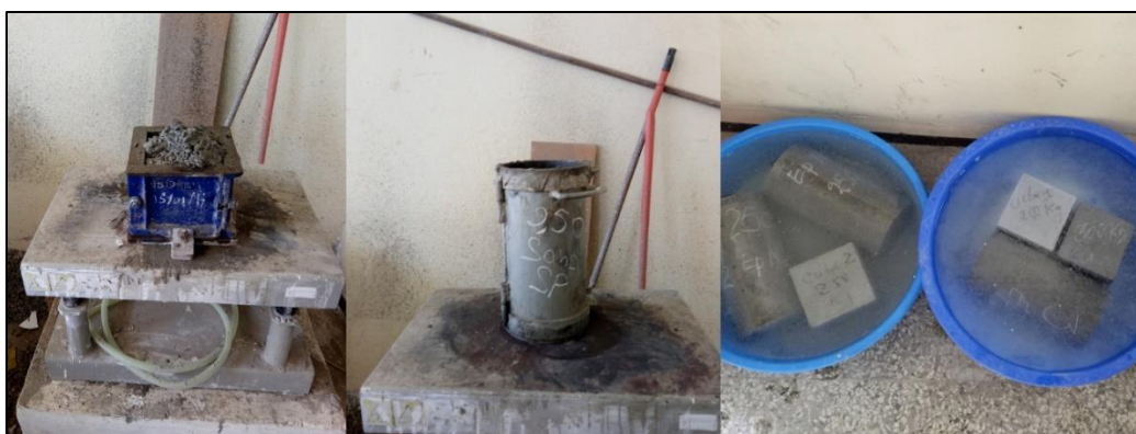
Figure II.24 : Confection des éprouvettes.
