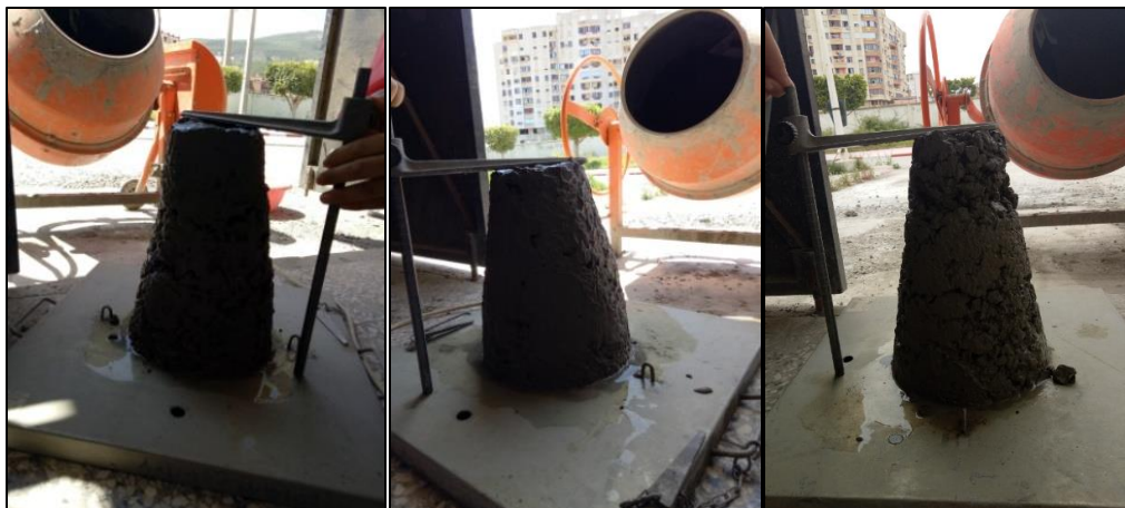
Figure II.15 : Essai de l'affaissement du B.O avec 250 kg du ciment
