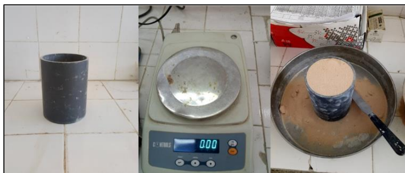
Figure II.1 : Matériels utilisés pour l'essai de la masse volumique apparente.
