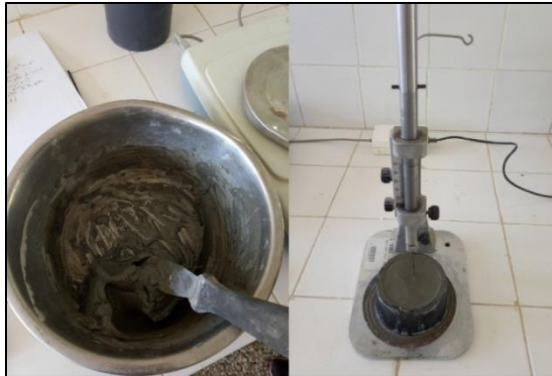
Figure II.9 : Essai de la prise du ciment.
