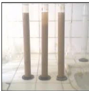
Figure II.6 : Essai de l'équivalent de sable.
