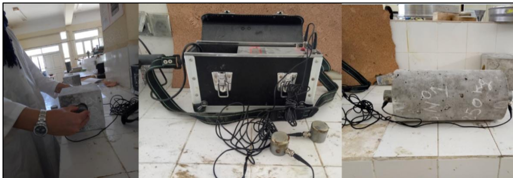
Figure II.30 : L'essai à l'ultrason.
