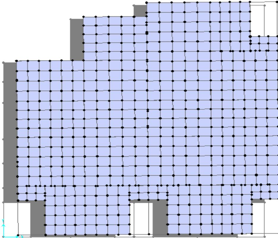
**Figure IV.5.** Mode 2 (Translation suivant l'axe X-X)
