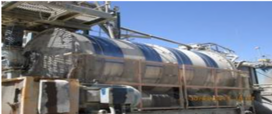
Figure II.16 : Broyeur à boulets à voie humide
